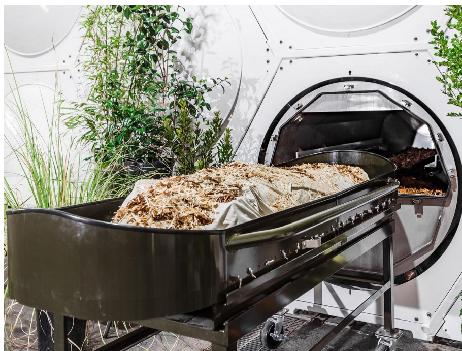
Figura 4 - Recipiente onde o cadáver é colocado com matéria vegetal para compostagem.
