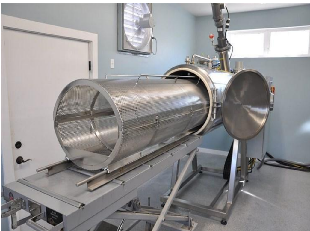
Figura 3 - Imagem ilustrativa da câmara onde ocorre o processo de aquamação.
